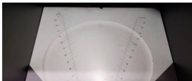
Figura 2. La proiezione della lente quando è situata nella vaschetta per la misura del diametro.
